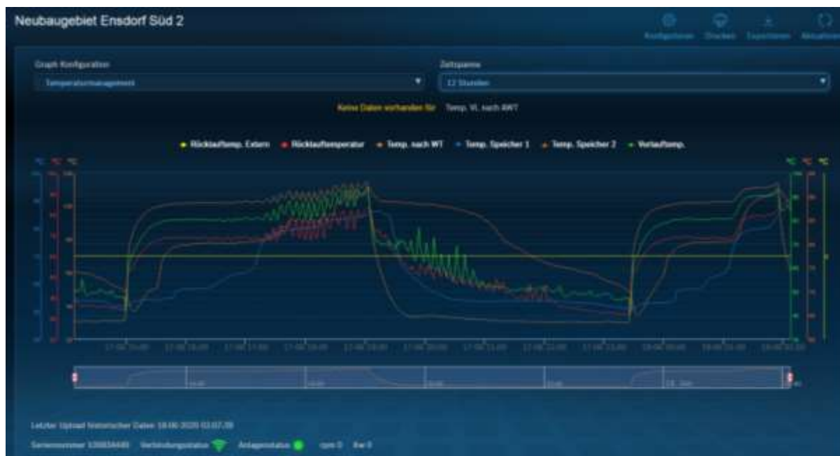
Auszug aus „MEC Remote“ mit verschiedenen Temperaturverläufen © Bosch Thermotechnik
